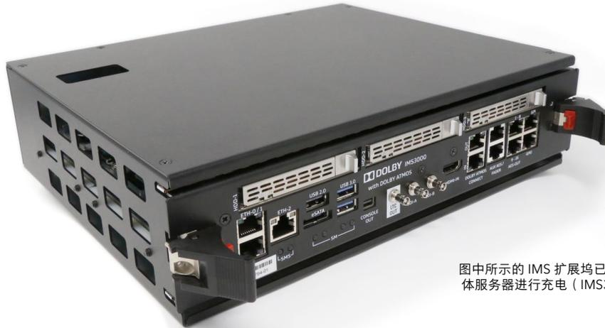
图中所示的 IMS 扩展坞已插入 IMS3000 媒体服务器进行充电 (IMS3000 单独销售)
